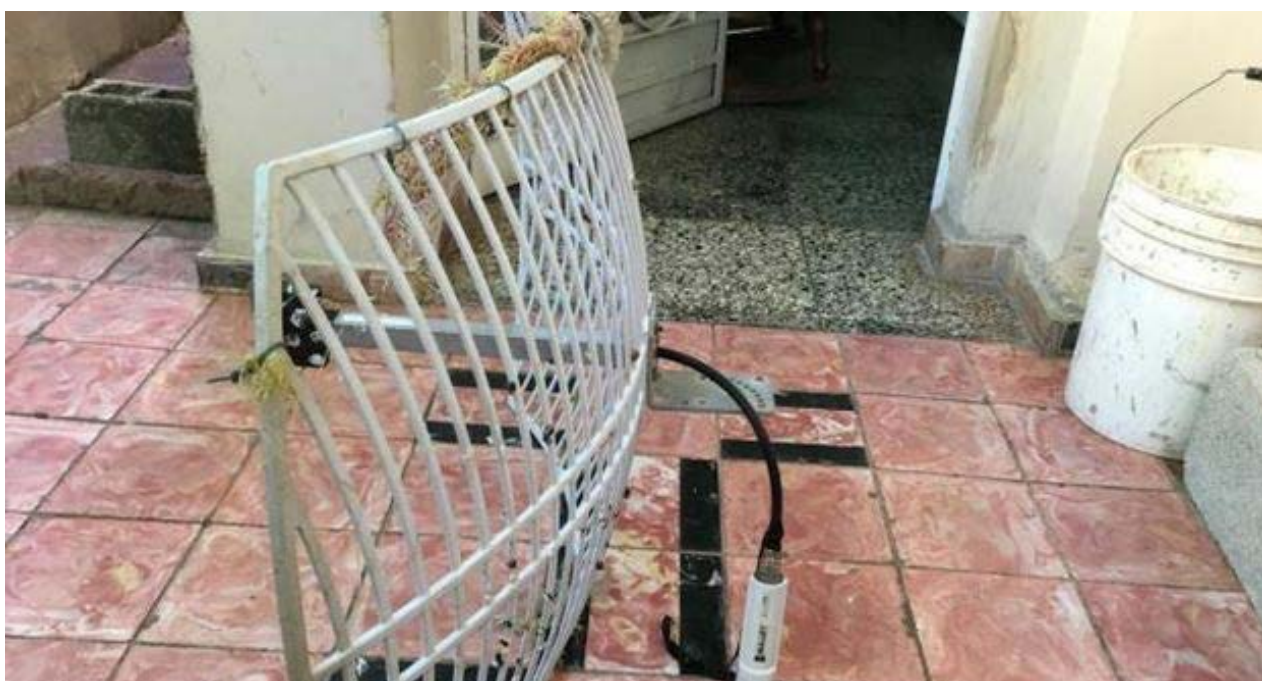
Antena casera para la recepción y envío de señales wifi, usada en las redes alternativas de conexión. (14ymedio)
