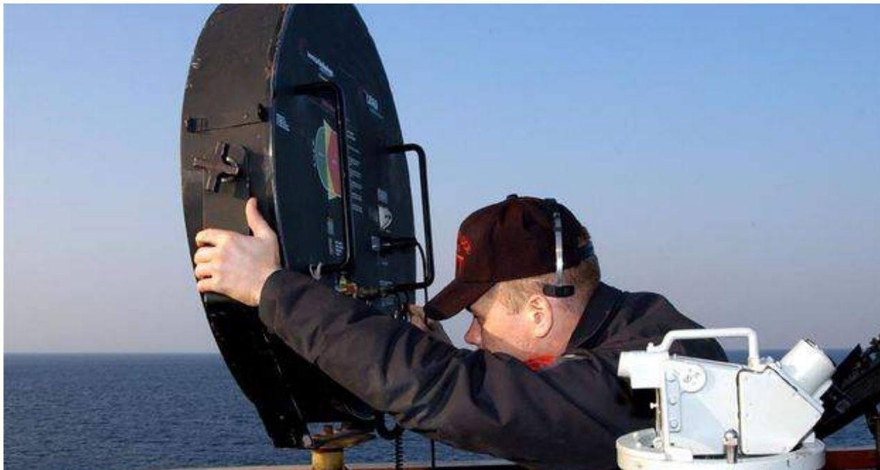
Dispositivo acústico de larga distancia utilizado en un buque de guerra de la armada estadounidense. (Wikimedia)
